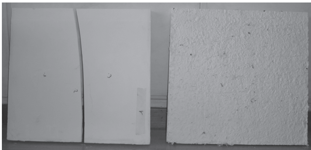
Fig. 3 – Pannello in solo gesso (sinistra) e pannello composito gesso-LDPE (destra) portati a rottura.
